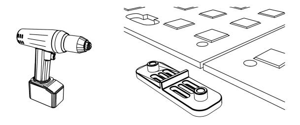
Wenn die Panels miteinander verbunden werden, entsteht eine zusammenhängende stabile Fläche, welche den Untergrund schützt und die Drucklast beim Befahren optimal verteilt.
